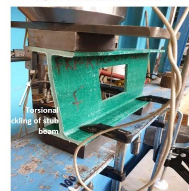
Fig. 19. Failure mode FRP-RHC-Co 4.
